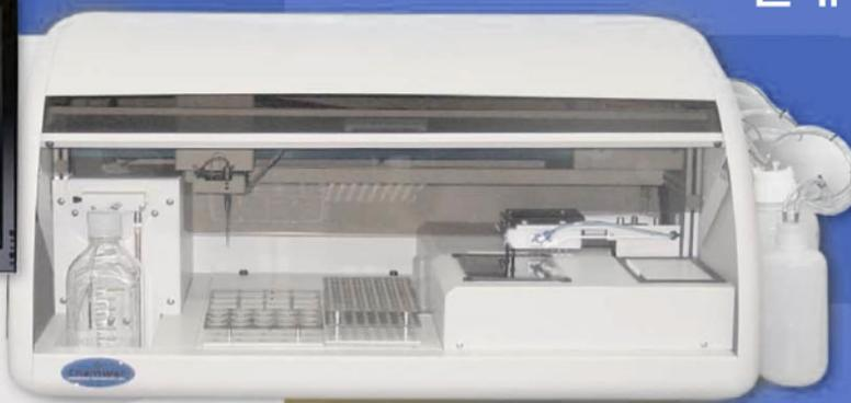
ChemWell® 2910 es un analizador totalmente automatizado capaz de correr tanto EIA (microelisa) y químicas en microposillos en forma simultánea. Para las reacciones de química clínica solo utiliza de 200ul a 250ul de reactivo dándole al laboratorio el más bajo costo por prueba del mercado.
